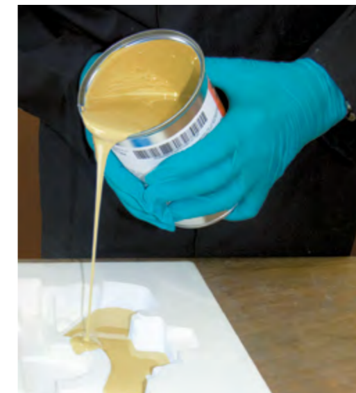
F160 z dodatkowym wypełniaczem w celu odlewania grubych odlewów.
