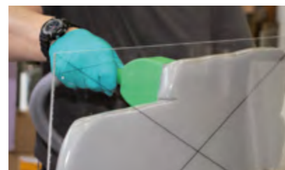
Tiksotropia pasty SC175 umożliwia aplikację na pionowych ściankach bez spływania.
