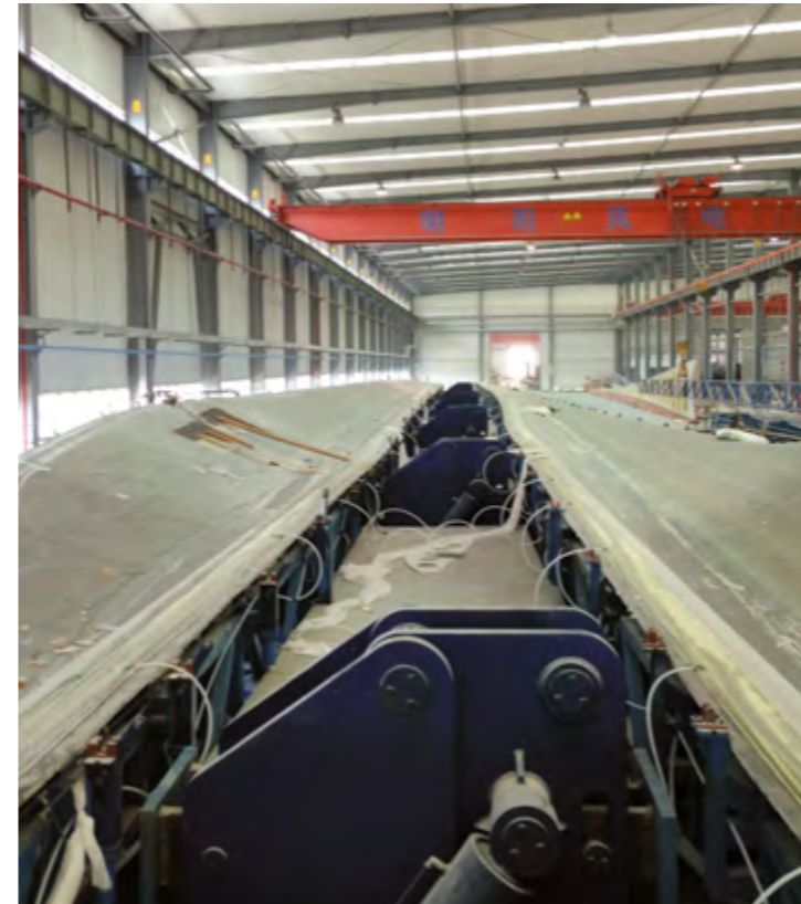
Infuzja skrzydła do elektrowni wiatrowej z żywicą Biresin® CR131.
