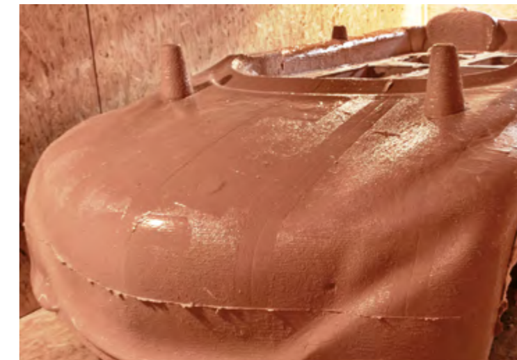
Produkcja modelu w skali 1:1 z systemu Biresin® M67 w jednym zalaniu.
