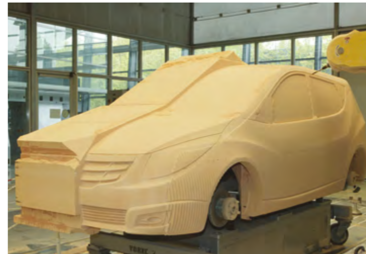
Model samochodu w skali 1:1 wykonany z płyt SikaBlock® M330 sklejonych klejem z Biresin® Kleber Orange.
