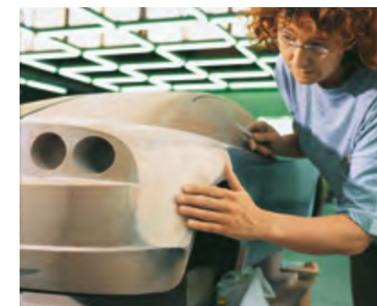
Modele frezowane z Prolab 65 / 70 spełniają najwyższe wymagania jakości powierzchni.
