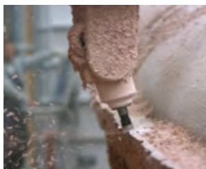
Pasta Biresin® M72 gwarantuje łatwą obróbkę CNC z wiórami i bez pyłu.
