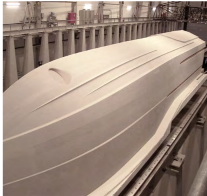
Kadłub jachtu o długości 43 m, wykonany w technologii epoksydowej pasty SC175 o idealnej powierzchni.
