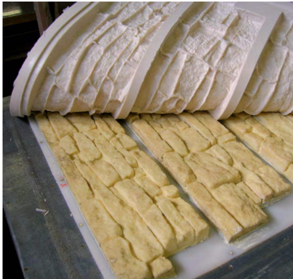
Nowy elastyczny system UR 58480 przeznaczony do formy do kamieni ozdobnych.
